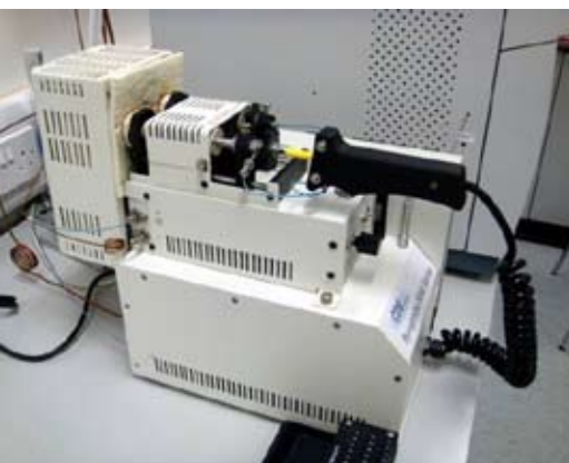
Pirólisis-GC-MS utilizado en Aston para la caracterización de los productos de descomposición pirólítica, bio-aceite y carbón
