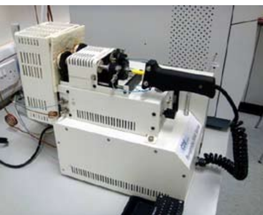
CG-MS usado para caracterizar os produtos de decomposição da pirólise, bio-óleo e bio-char
